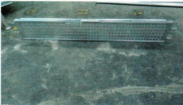
Fotografía 6.7: Vista general tablón (Plataforma metálica).
