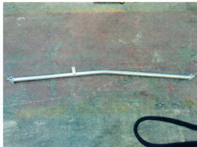
Fotografía 7.1.2.6: Plastificación probeta FB-RDB207-03
