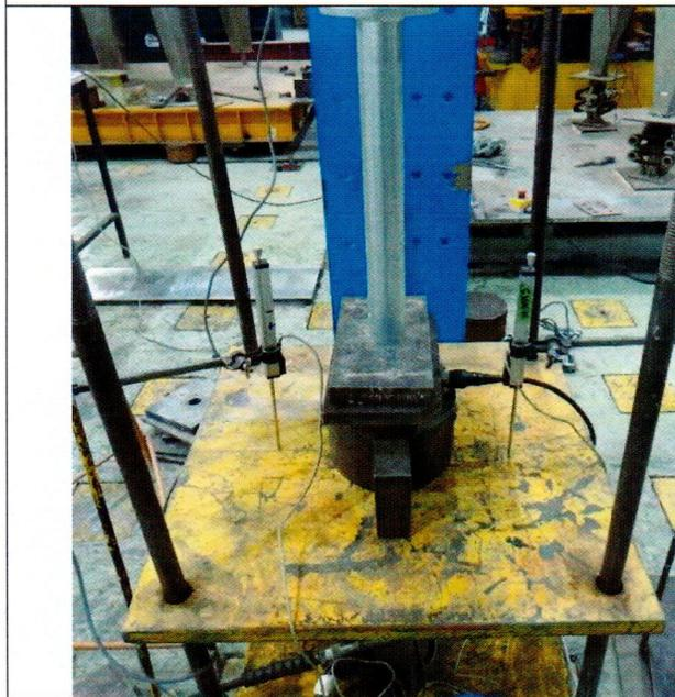
Fotografía 7.2.1.3: Sensores de deformación axial
