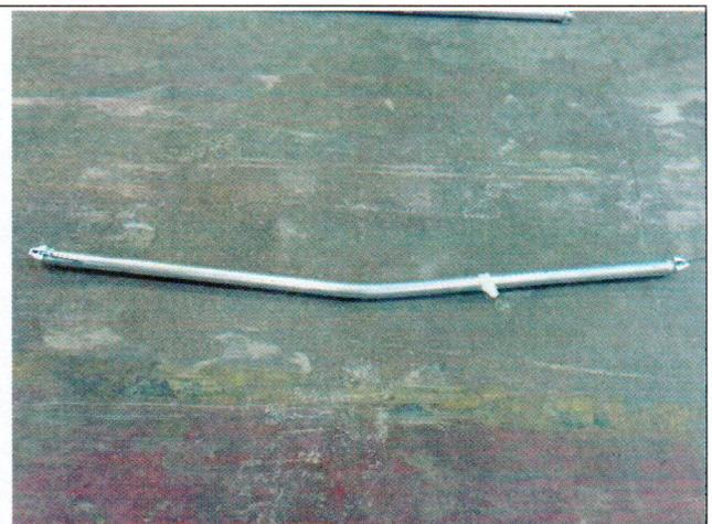
**Fotografía 7.1.2.2: Plastificación probeta FB-RDB207-01**
