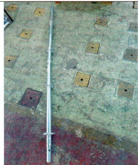
Fotografía 7.2.2.2: Plastificación probeta CPD-RD66-01
