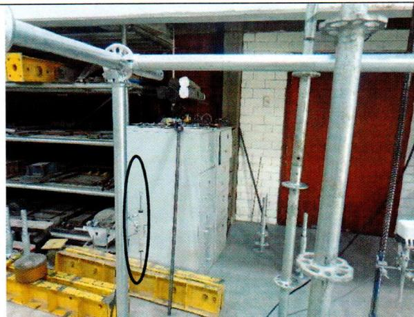
Fotografía 7.1.1.4: Detalle de uno de los transductores utilizados en los extremos de la baranda, se muestra  $\delta_1$ .
