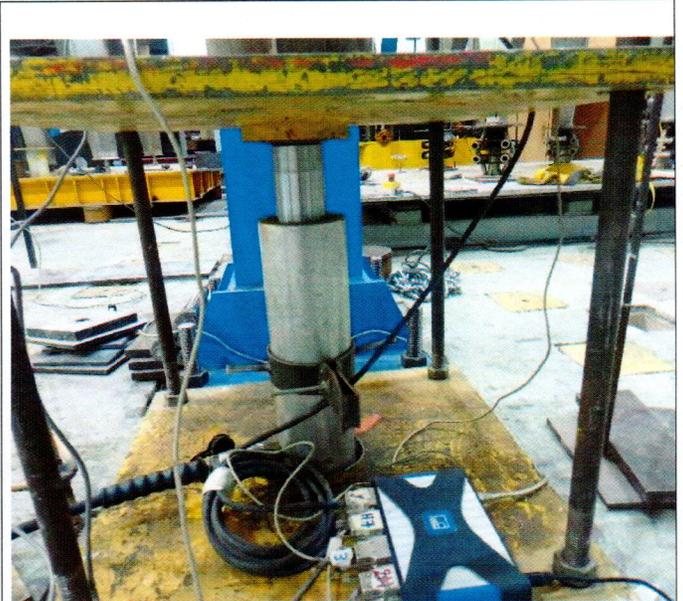
Fotografía 7.2.1.2: Detalle del apoyo del gato hidráulico
